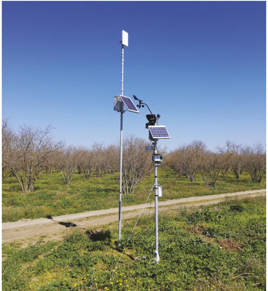
▲ Fig. 10 - Capannina agrometeorologia e antenna alimentate tramite pannelli solari installati in prossimità della viabilità dell'azienda ospitante la sperimentazione PANTHEON.
