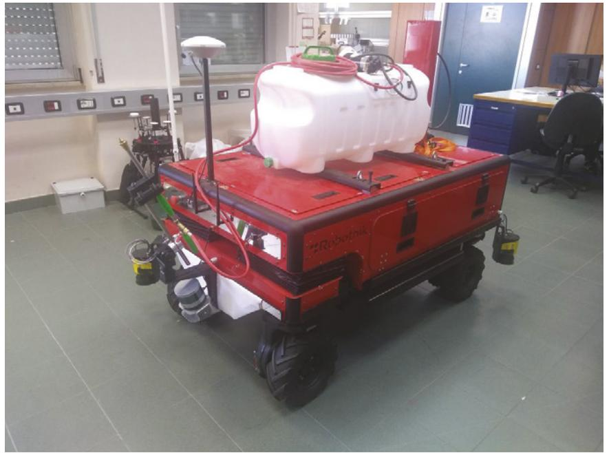
▲ Fig. 8 - Prototipi dei robot terrestri implementati per il progetto PANTHEON. Si noti la versione dedicata alla acquisizione dei dati in campo (a) e la versione progettata per l'esecuzione automatica di alcune operazioni culturali, come la distribuzione localizzata di erbicida e/o fitofarmaci (b). (Foto Dipartimento di Ingegneria UNIROMA3).
