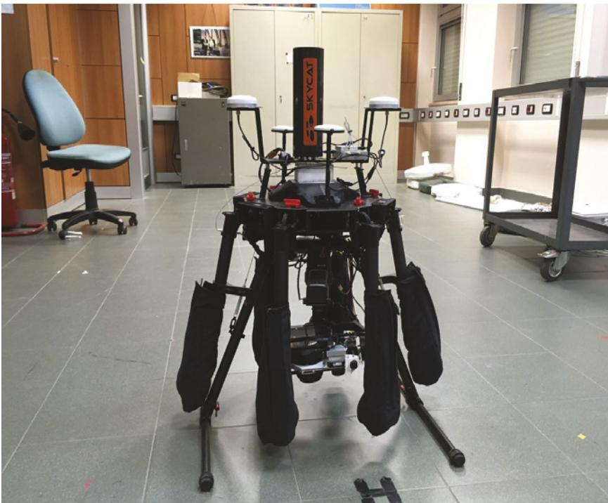
▲ Fig. 9 - Prototipo di drone implementato per la acquisizione di dati in tempo reale durante i sorvoli in campo (Foto Dipartimento di Ingegneria UNIROMA3).
